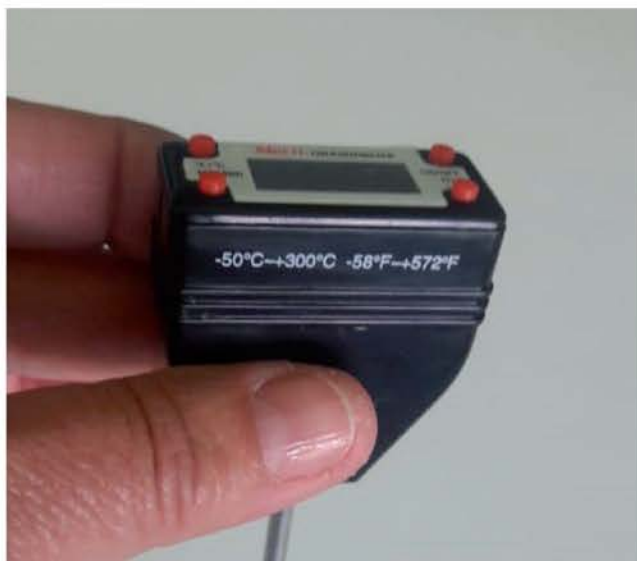
Foto 10. Arriba, termómetro marcando con lanza al interior de la pila de compost. Abajo, termómetro de pinchar pequeño.
